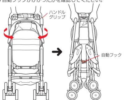
4. 手元ロックスライダーを元に戻し、折りたたみをロックする。折りたたみレバーがロックされます。
