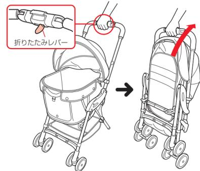
3. 3面折りにするには、折りたたみレバーから手を離し、左右のハンドルグリップを逆手で持ち、内側にたたむ。必ず自動フックがかかったかを確認してください。
